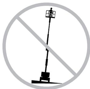
Se o alarme de inclinação soar quando a plataforma for abaixada: não estenda, gire ou eleve a lança acima da posição horizontal. Mova a máquina para uma superfície firme e nivelada antes de elevar a plataforma.
